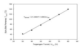
Gambar 8. Grafik hubungan antara tegangan output toroid dengan suhu elemen pemanas
