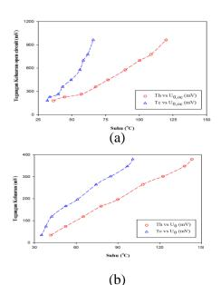
Gambar 9 (a) Grafik Tegangan dengan suhu tanpa beban, (b) Grafik tegangan dengan suhu diberi beban
