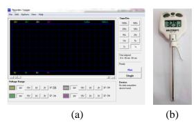
Gambar 7. (a) Perangkat lunak (software) ADC Velleman PCS10/K8047 yang merubah data suhu ketegangan. (b). Sensor suhu digital Voltcraft DET1R
