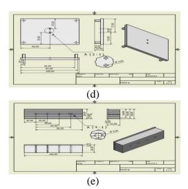
Gambar 2. (a) Desain dudukan elemen peltier, (b) Desain blok sisi Panas, (c) Desain blok sisi dingin, (d) Desain kaki dudukan dan (e) Desain Heatsink
