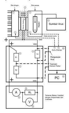
Gambar 4. Susunan Eksperimen Generator Termoelektris
