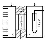
Gambar 1. Rangkaian dudukan eksperimen untuk elemen Peltier sisi panas dan sisi dingin.
